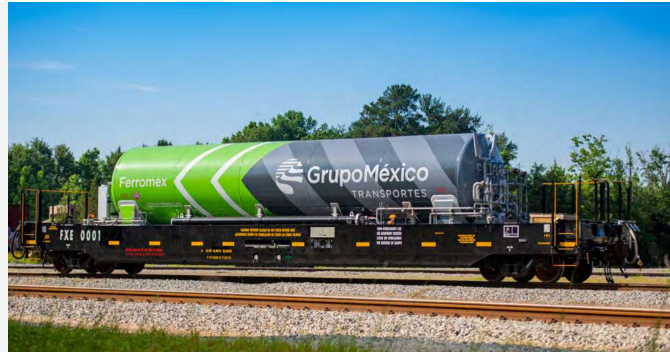
📷 Tender con Gas Natural Licuado para locomotoras híbridas, Ferromex, México.
